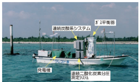
図2 係留した小型ボート上で、海水のCO 2 と、全炭酸、アルカリ度、大気CO 2 の変動を、連続で計測する測定システム。白化とその後の回復に伴う群集代謝(光合成、呼吸、石灰化)とCO 2 を通年で観測することに成功した。
