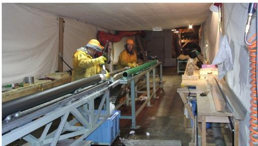
図4 南極ドームふじ基地における氷床深層コア掘削。掘削毎のドリルの点検を行っている。南極観測の第二期ドーム計画では、2003/2004年からの夏のシーズンに掘削を行なっている。2名づつのチームが3交代で24時間掘削を行っている。
