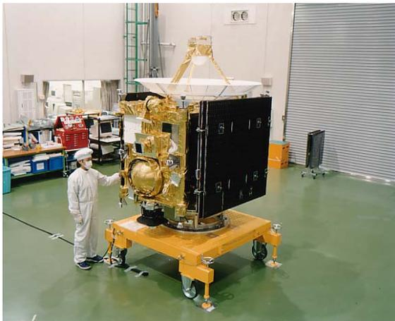
図2 はやぶさ探査機（打ち上げ直前）。左側面の丸く見えるのが地球に帰還するカプセル。その下に黒く見えるのが試料採集器（打ち上げ後、長さ1 mに伸展される）。右側面は太陽電池パネル（打ち上げ後、伸展）、上面は地球との交信用高利得アンテナ。（JAXA/ISAS）
