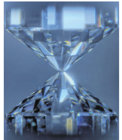
超高压実験で用いるダイヤモンドアンビル。2 つのダイヤモンドで加圧し、レーザーで加熱することにより、試料を地球中心の圧力 (364 万気圧) と温度 (約 5000 ケルビン) を超える超高压高温状態にすることができる。
