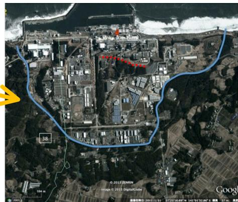
図 6 地下水の導水路案(図中青線)
