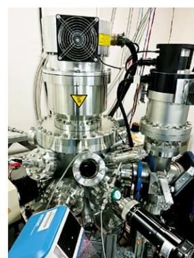
図2 星間分子雲環境での化学プロセスを検証する反応チャンパー。上部に取り付けられたターボ分子ポンプでチャンパー内を排気する。手前右の黒い筒は真空紫外光照射用の重水素ランプ、手前左は四重極型質量分析計。
