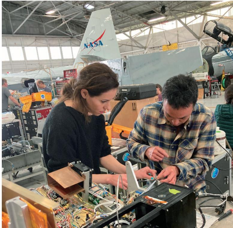
図 1 成層圏観測のための航空機 NASA WB-57 (後方) に搭載するエアロゾル測定装置の一つの整備を手伝う筆者 (手前右)。このような航空機観測キャンペーンでは、初フライトの前に 3 週間くらいかけて機器の現場調整・搭載・配線・配管・通信テストなどが行われる。WB-57 に搭乗できるのは宇宙服のような加圧スーツをきたパイロット 2 名だけなので、各搭載装置の飛行中のオペレーションは全自動あるいはリモート通信で行われる。撮影者: Joshua P. Schwarz
