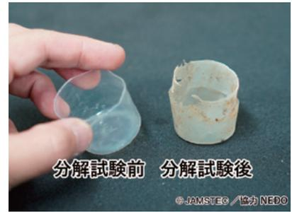
図3 分解試験を行っていないコップ型の透明板紙（左）と、初島沖深海底に設置・回収されたサンプル（右）
