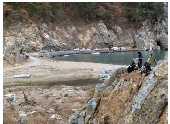
図 1 宮古市姉吉地区の津波で被災した谷と地上型レーザー・スキャンによる測量。
