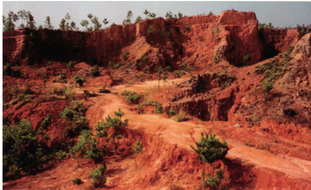
図2 竜南に近い五里亭(ウーリティン)付近のイオン吸着型鉱床。源岩の花コウ岩の鉄含有量が高いため、酸化鉄による赤色化が激しい。REE 鉱物は主に褐レン石 [(Ca, Ln)_2(Al, Fe)_3(SiO_4)_3(OH)] であり、そのため重希土類に乏しく、採掘は早期に中止された。2003年8月筆者撮影。
