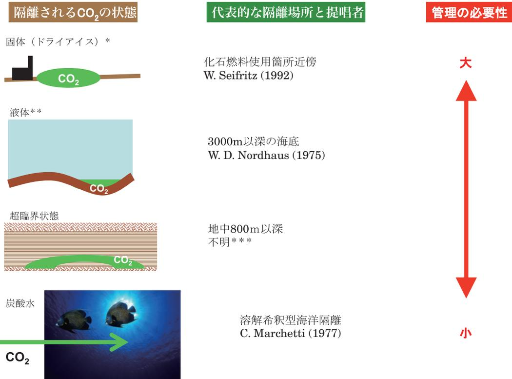
図 1 二酸化炭素隔離のさまざまな方法。\*) 大隅 (1993) は、石炭火力発電所敷地に「現代のピラミッド」を建造するアイデアとして紹介した。\*\*) Marchetti (1977) に紹介されているが、海洋を利用する隔離においては環境影響の観点から容器を用いるべきであるとの指摘もされている。\*\*) 100 年近い歴史をもつ天然ガスの地下貯蔵の実績や 40 年以上の歴史を持つ EOR での CO<sub>2</sub> 利用などの事例から、石油・天然ガス開発の業界では当然視されていた隔離方法であった。
