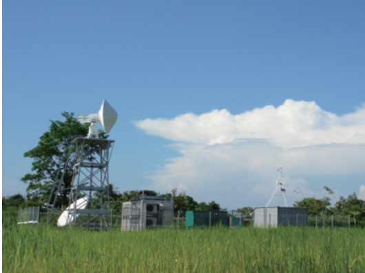
図3 スマトラ島西岸バダン空港近くに海洋研究開発機構が JEPPI で設置したドップラーレーダ他(左)。レーダ反射強度および反射波のドップラシフトが示す雲内の降水粒子の分布と雲内の風の挙動(右)。(海洋研究開発機構地球環境観測研究センター 櫻井南海子氏提供)
