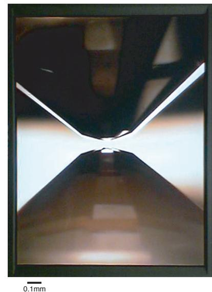
図1 超高压発生用ダイヤモンドアンビルの先端部。ブリリアントカットの下端頂点を平坦に研磨したダイヤモンド結晶 2 つを上下に対向させ、その平坦部分に試料を挟み込んで高圧力を発生させる。平坦部分の直径は 60 μm。
