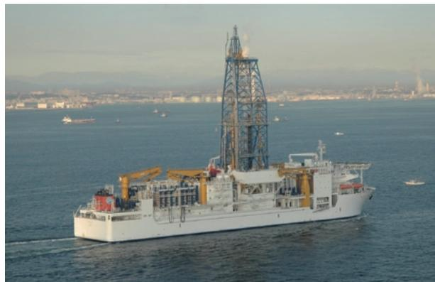
図1 東京湾を航行中の「ちきゅう」。全長210m、排水量57,000トンの巨大な船である。
