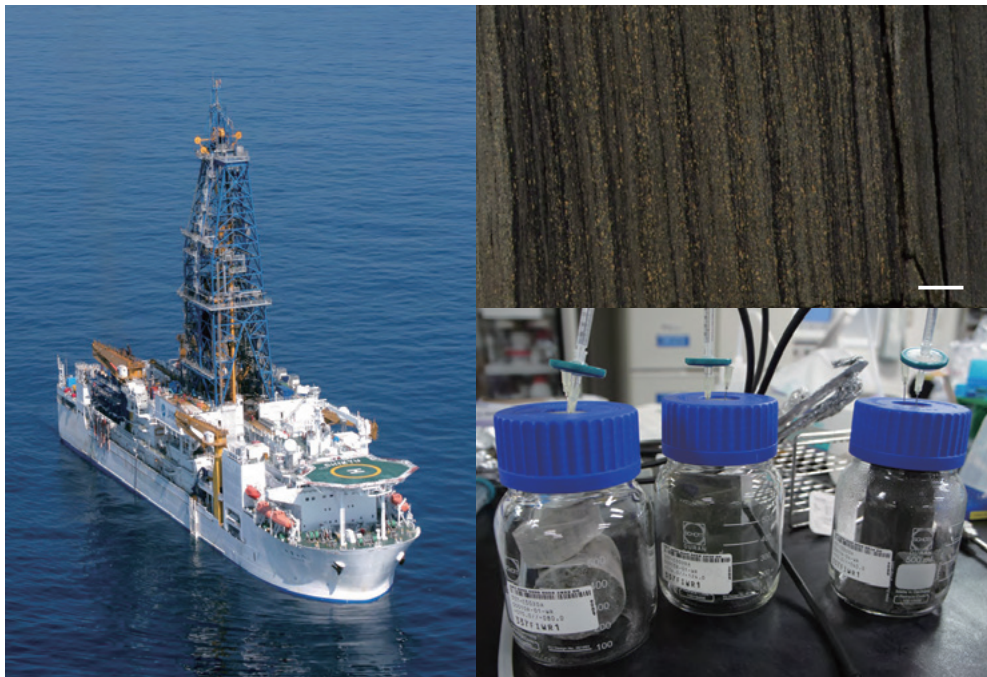
図 1 下北八戸沖石炭層生命圏探査を行う地球深部探査船「ちきゅう」(写真左)。海底下深部から採取された堆積物サンプルには、石炭（黒色部分）や炭酸鉄（黄色部分）などが含まれ、過去 2000 万年の大陸沿岸の堆積環境が記録されていた (写真右上：右から左に向けて深度が増す。スケールは 1 cm)。船上で X 線 CT スキャンによって選別された高品質な部位から、2000 を超える生命科学分析用のサンプルが採取された (写真右下)。(写真提供：JAMSTEC, 稲垣史生)
